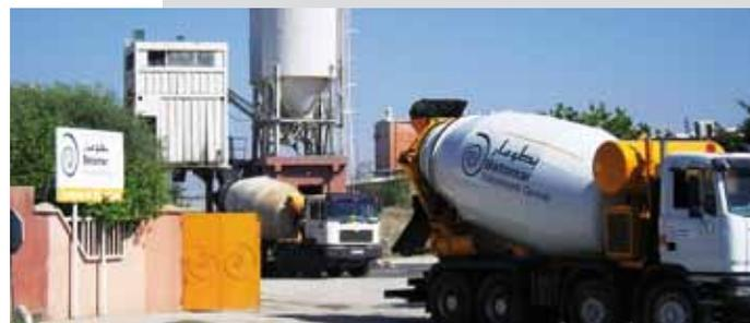
par des camions toupies directement sur les chantiers aux entreprises de construction. En garantissant une qualité régulière, une cadence importante des livraisons et une assistance à la mise en œuvre, le BPE permet aux entreprises de gagner du temps et d'assurer leurs prestations dans des délais plus rapides.
